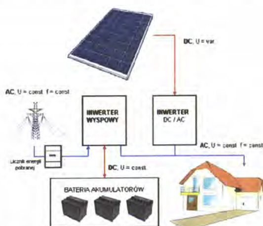
Rysunek 23. Schemat instalacji mieszanej 174 (oznaczenia: DC- prąd stały, AC-prąd przemienny, U- napięcie, f-częstotliwość, var.-zmiennie, const.- stałe)
