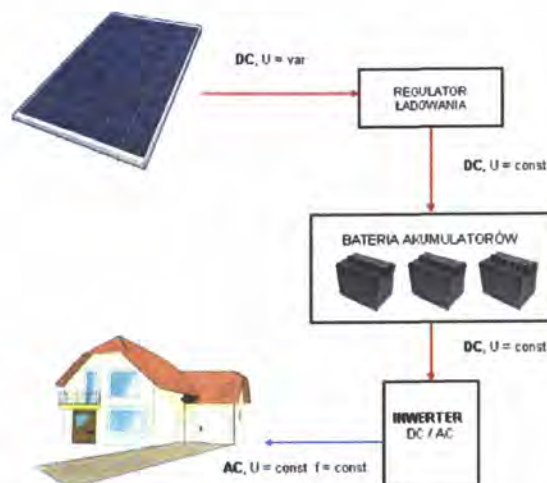
Rysunek 22. Schemat instalacji OFF-GRID 173 (oznaczenia: DC- prąd stały, AC-prąd przemienny, U- napięcie, f-częstotliwość, var.-zmiennie, const.- stałe)
